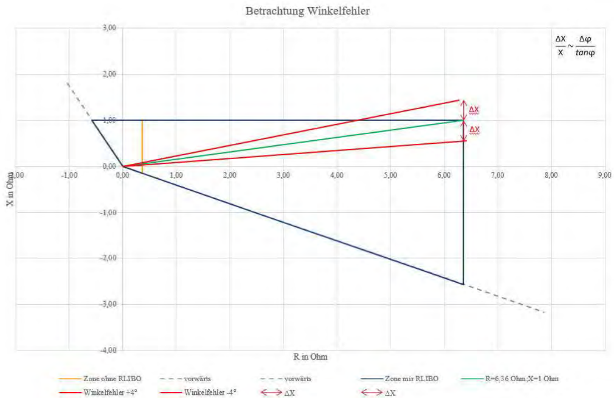
Bild 62 Winkelfehler bewirkt einen Reaktanzmessfehler, der mit zunehmenden R/X -Verhältnis größer wird
