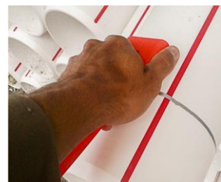
4. Rabotage de la surface du tube à la raboteuse ou à la main
