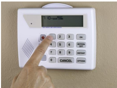
Système d'alarme antieffraction
