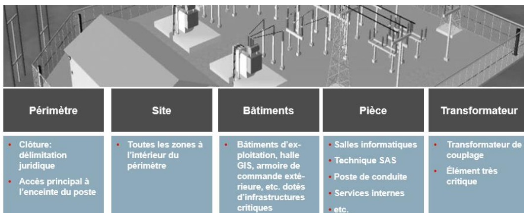
Figure 4 Schéma définissant les différentes zones de protection d'une sous-station
