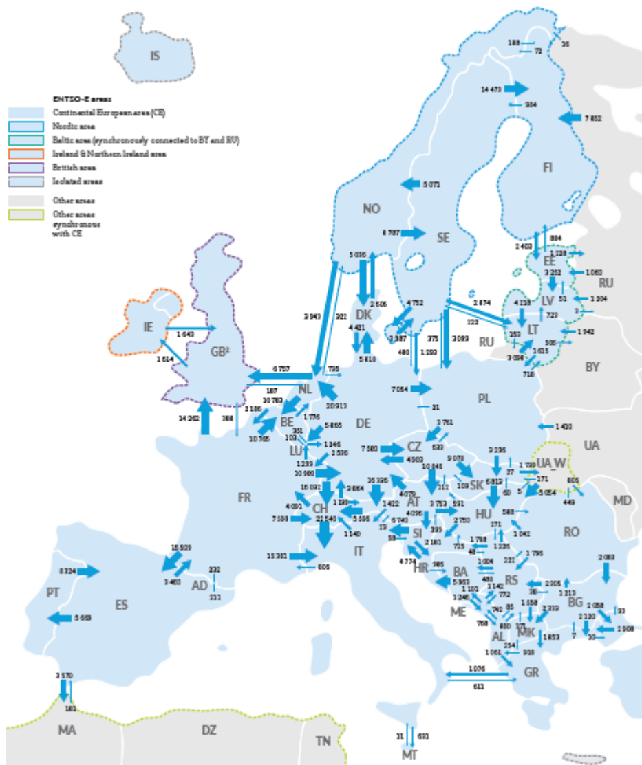
Illustration 8. Flux physiques de courant au sein du réseau interconnecté REGRT-E (état en 2018, données en GWh). Source: REGRT-E 2019.
